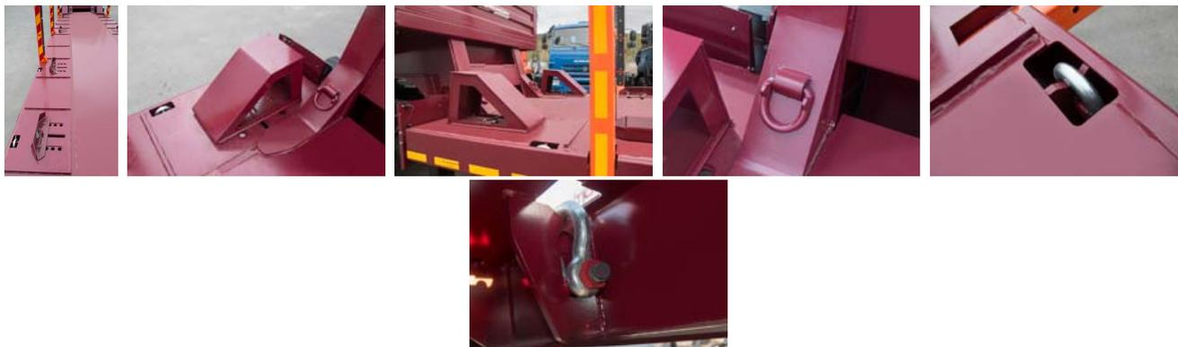
В стандартной комплектации полуприцепы-тяжеловозы «УралСпецТранс» оснащаются **уширителями с комплектом настила**. Уширители имеют **выдвижную конструкцию** и в собранном положении располагаются в нишах под настилом платформы. Для перевозки негабаритной техники уширители выдвигаются и на них укладываются щиты. Так же в стандартной комплектации полуприцепы-тяжеловозы оснащаются **выдвижными знаками «НЕГАБАРИТ»**.
