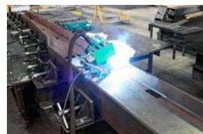
Сварочные работы мелкого масштаба выполняются на **современных сварочных полуавтоматах**. Сварка рамы осуществляется во вращателе, что обеспечивает максимально комфортную позу сварщика во время выполнения сварочных операций. Также отсутствие потолочных швов в разы улучшает качество сварочного шва.
