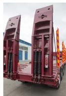
Въезд на грузовую платформу осуществляется **трапам (сходням) либо аппаратам**. Аппараты в транспортном положении образуют **ровный пол с основной грузовой платформой**. Трапы в транспортном положении **поднимаются вверх**. Трапы оснащены пружиной, что облегчает их подъем и опускание. При движении полуприцепа-тяжеловоза **трапы и аппараты надежно фиксируются**. Возможно изготовление трапов с гидравлической системой подъема.
