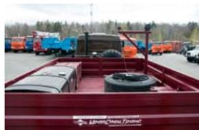
На гусаче трапа «УралСпецТранс» смонтирована **бортовая платформа**. Бортовая площадка предназначена для **транспортирования необходимых принадлежностей**. Так на гусаче размещены штатные крепления щитов уширителей, кронштейн крепления запасного колеса и укосина для его подъема и опускания, дополнительный топливный бак.
