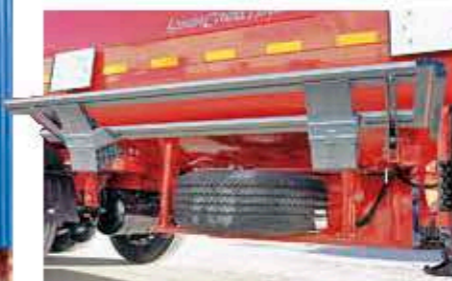
Заспное колесо скрыто за подъемным противоподкатным ограждением
