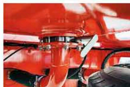
Слив возможен из отсеков поочередно или одновременно, если тип ГСМ один
