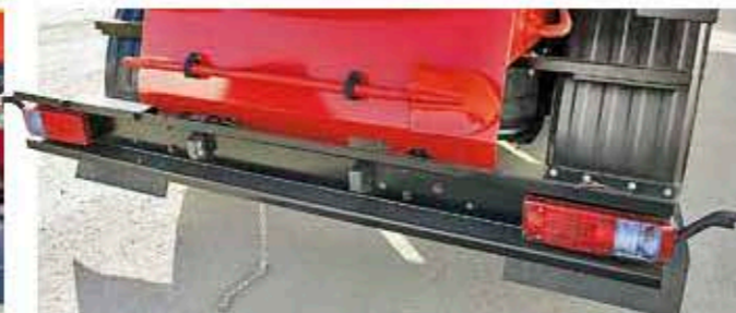
Заднюю часть полуприцепа-бочки защищает противоподкатный брус с встроенной в него светотехникой
