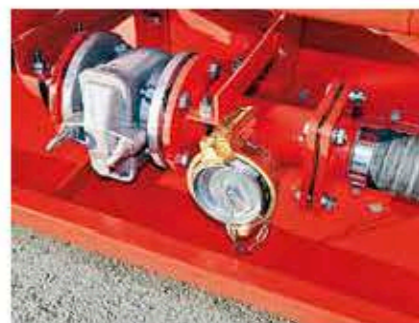
Система раздачи топлива оснащена быстроразъемными соединениями
