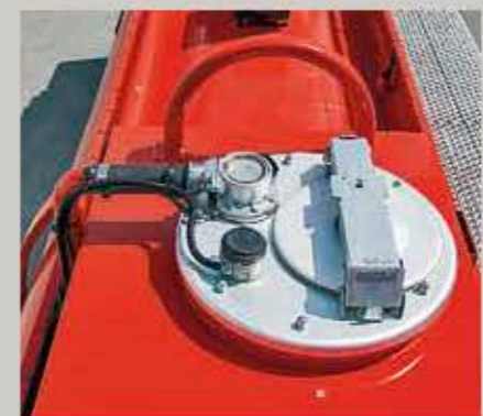
Полуприцеп-цистерна оснащена системой рекуперации паров
