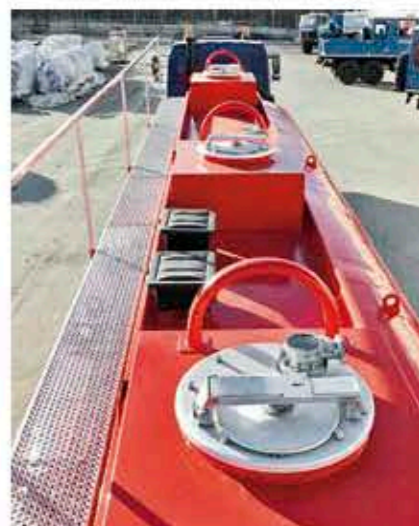
Доступ к люку наливной горловины – с удобной площадки обслуживания
