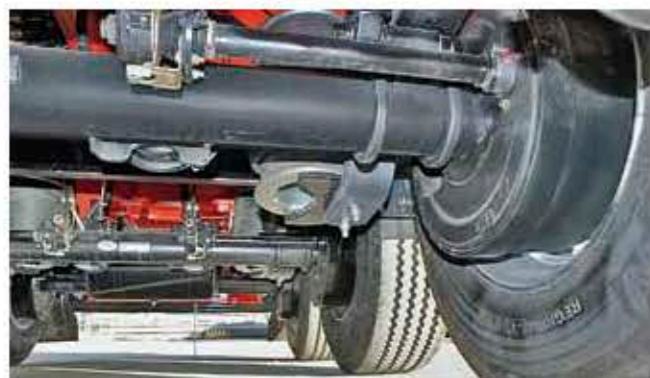
Тормозные механизмы барабанного типа с автоматической регулировкой зазора между колодкой и барабаном
