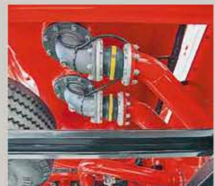
В системе раздачи топлива применили коррозионностойкую аппаратуру
