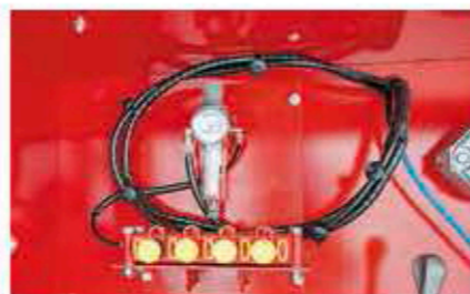
Система раздачи топлива оснащена пневматическим управлением
