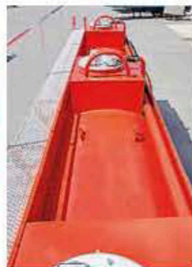
Емкость разделена на три независимых отсека различного объема
