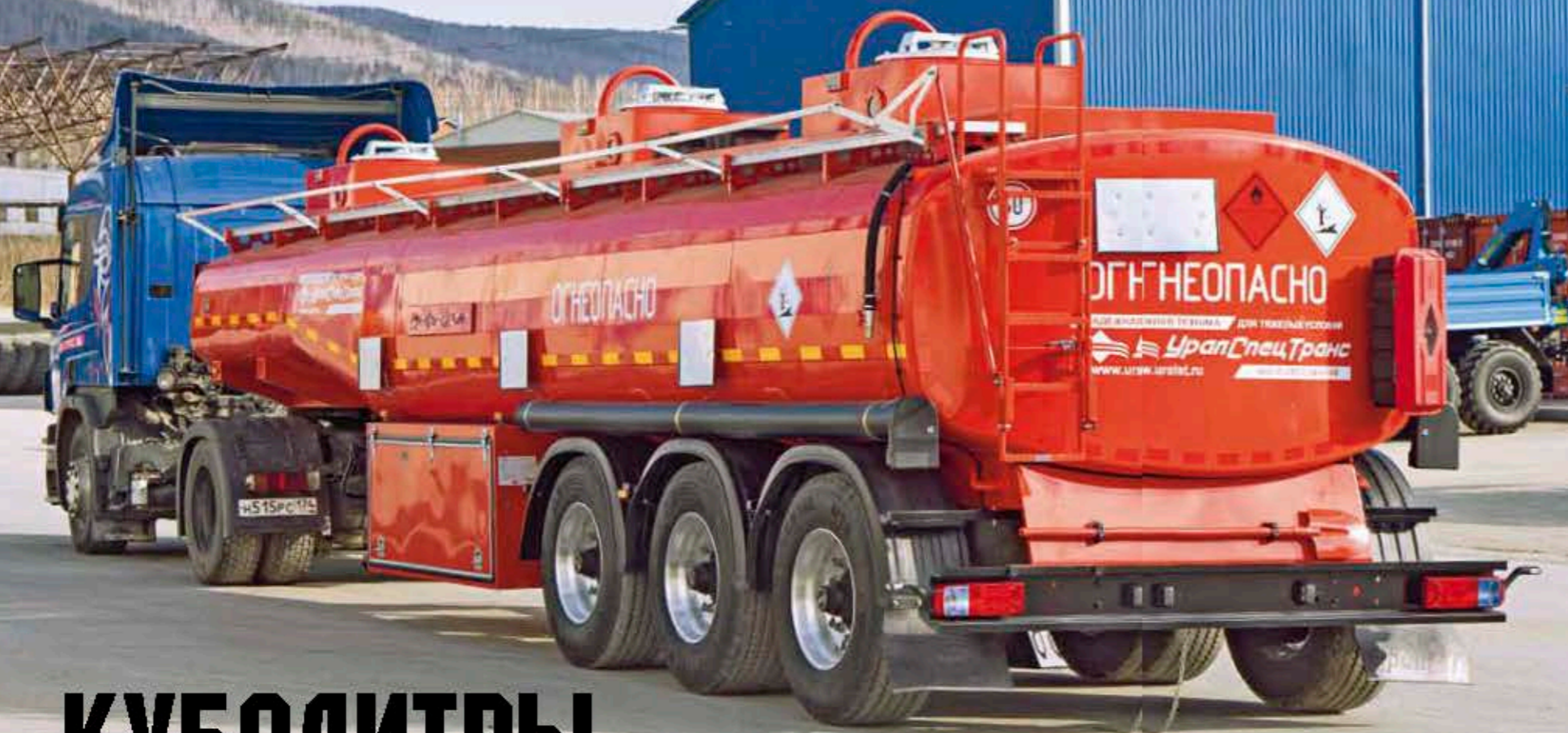
Заспное колесо скрыто за подъемным противоподкатным ограждением
