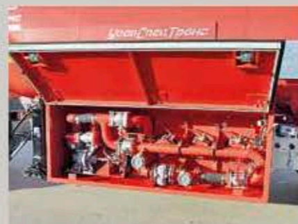
Исполнение системы опорожнения/налива с перекачивающим насосом
