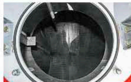
Все швы емкости проходят неразрушающий ультразвуковой контроль
