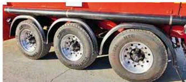
Трёхосный осевой агрегат с односкатной ошиновкой. На заднюю тележку приходится нагрузка в 21 тонну
