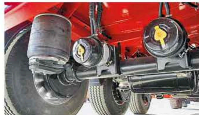
Шасси полуприцепа – трехосное, одно- или двухскатное, с пневматической подвеской и передней подъемной осью
