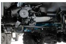
Применение **рулевого механизма RBL (Германия) с интегрированным усилителем** позволяет **снизить прилагаемое усилие на рулевом колесе, увеличить грузоподъемность передней оси, сократить расходы на ТО**. Комплектация системы рулевого механизма **беззазорными наконечниками** позволила **уменьшить углы люфтов**, что положительно отразилось на **курсовой устойчивости и управляемости автомобилем**.
