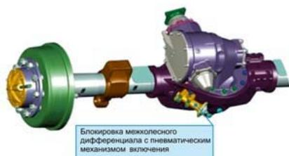
Блокировка межколесного дифференциала с пневматическим механизмом включения
