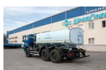
АЦПТ-10 УСТ-5453 Камаз 43118-46, Автоцистерна для питьевой воды, 10 куб.м., насос, термоизоляция
