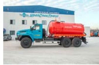
МВ-10Т КО УСТ 5453 Урал 4320-72 NEXT, Автоцистерна вакуумная "термос", насос КО-505, Урал 4320-72NEXT, термоизоляция
