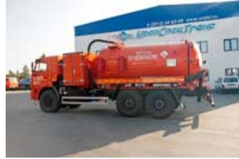
АКН-10Т-ОД PNR УСТ5453 Камаз 43118-3078-RF, Автоцистерна вакуумная с открывающимся днищем, 10 куб.м., термоизоляция
