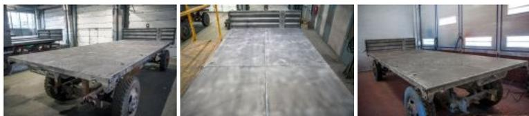
**Стойки бортов** проходят процедуру **катафорезного грунтования**, способствующего надежному закреплению грунтовочного материала, покрытию металла равномерным тонким слоем даже в труднодоступных местах. Такой метод обеспечивает **надежную антикоррозионную защиту и механическую прочность** финишного покрытия.
