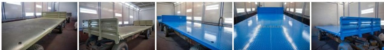
Окраска Бортовых платформ осуществляется в современной окрасочно-сушильной камере. Применение **высококачественных лакокрасочных материалов**, а также **соблюдение технологических процессов** подготовки, грунтования и окраски в современной окрасочно-сушильной камере обеспечивают стойкость лакокрасочного покрытия в экстремальных условиях эксплуатации.
