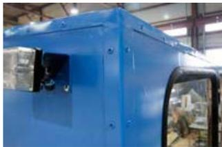
**Наружная обшивка автофургона** выполняется из листовой стали толщиной не менее 1,2 мм. Возможен вариант исполнения наружной обшивки из других материалов. Крепление обшивки к каркасу *автофургона* осуществляется с помощью точечной сварки. Все узлы и соединения, испытывающие большую нагрузку, выполняются при помощи двухсторонней стальной клепки.
