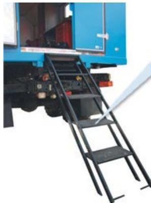
Для доступа к нишам, а также входа персонала и перемещения груза внутрь **автофургона** предусмотрены **съемная лестница** и **выдвижной трап**. Выдвижной трап в транспортном положении убирается в нишу под полом автофургона. Конструкция трапа предусматривает **широкие ступеньки**, по которым легче производить спуск и подъем внутрь фургона.
