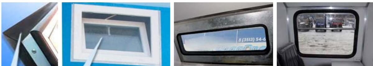
**Для увеличения тепло и шумоизоляции** проемы дверей и люков окантованы тройным, а окна на скосах **автофургона** двойным контуром высококачественного уплотнителя.
