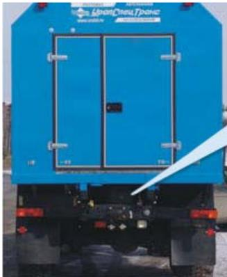
Генератор располагается под полом автофургона между лонжеронами рамы автомобиля, что позволяет увеличить рабочее пространство внутри кузова-фургона. Привод генератора осуществляется от коробки отбора мощности, через штатную карданную передачу, обеспечивая этим надежность и компактность конструкции привода генератора.
